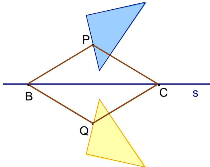
Le mécanisme est un losange articulé dont les deux sommets sont contraints à se déplacer sur une droite  $S$ . Il possède deux degrés de liberté : les sommets libres du losange,  $P$  et  $Q$  peuvent évoluer dans des bandes horizontales situées de part et d'autre de  $S$  :  $P$  au dessus et  $Q$  au dessous. À chaque position de  $P$  correspond une seule position de  $Q$  et réciproquement (correspondance biunivoque).
