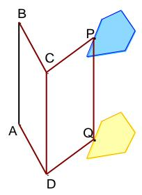
Le système est constitué de deux parallélogrammes articulés, ABCD et DCPQ situés dans le même plan et possédant le côté CD en commun.
